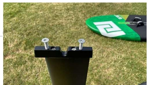
Visse le foil sur le mat et serre au contact les vis, puis serre fermement.
